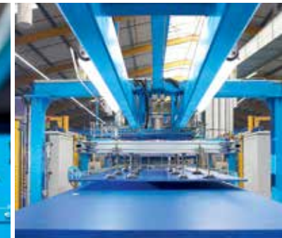
Bei Röchling werden Kunststoffplatten aus PVC und PE extrudiert
