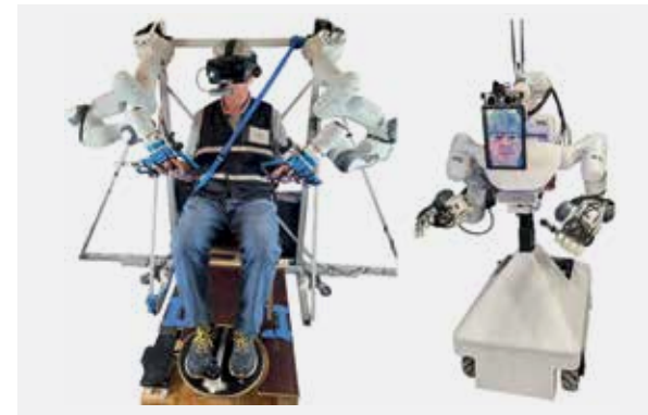
Avatar-Bedienstation und Avatar-Roboter | Foto: AG Autonome Intelligente Systeme
