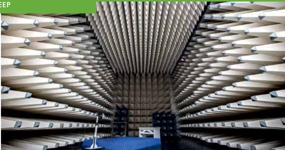
In der EMV-Halle werden elektronische Geräte und Systeme auf ihre elektrische Unverträglichkeit getestet
