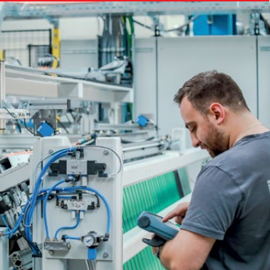
Einrichten der automatischen Widerstandsschweißzelle
